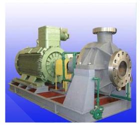
该系列泵为"双壳体结构",即"环形流道+导叶扩散器结构",压力转换在导叶扩散器内进行,环形流道出口只是导流与承压且热变形均匀;泵体不承受冲击、出口段接触液体,但因面积最大化,磨损相对最小,寿命相对长。
